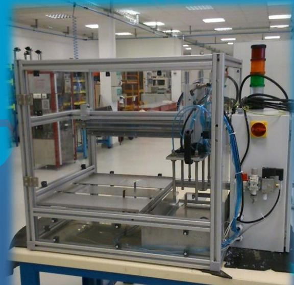
**L'ESAT, Les Ateliers de l'Espoir de Cesson Sévigné, a souhaité automatiser le comptage de sachets à pain. Ce dispositif doit permettre de dépiler une liasse de 500 à 1000 sachets à pain et de les empiler en liasses de 10 à 25 sachets suivant la demande de leurs clients.**
